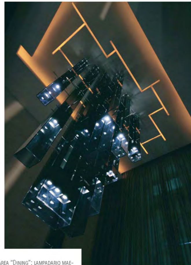
NELL'IMMAGINE DELLA PAGINA ACCANTO, L'AREA "DINING": LAMPADARIO MAESTOSO DI 5,20 M. DI LUNGHEZZA DISEGNATO DALL'ARCHITETTO LIPPARINI E REALIZZATO SEMPRE DA SAVORITI ITALIA; COSTITUITO DA NOVE "BOX" APPESI IN CRISTALLO FUMÉ, ANCORATI A SCATOLARI IN ACCIAIO CONTENENTI I FARETTI. NELLA FOTO IN BASSO A DESTRA, PANNELLO SCORREVOLE IN CORIAN® BIANCO, INCISO A LASER SU DISEGNO CON INSERTI IN MARMO ROSSO.
